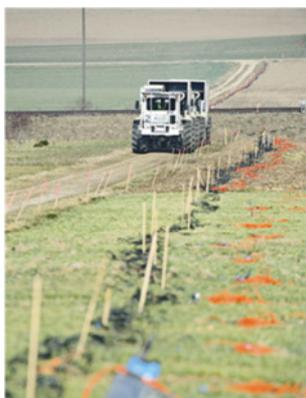
**Bildbeschreibung:** Vibrationsfahrzeuge erzeugen Schwingungen im Untergrund, die gemessen werden und ein Abbild des Untergrunds ergeben. Quelle: Beat Müller
