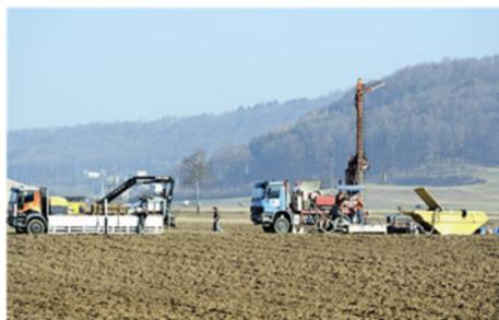
**Bildbeschreibung:** An ausgewählten Punkten des Messgebiets werden sogenannte Aufzeitmessungen durchgeführt. Zu diesem Zweck werden in Gebieten mit komplexer Oberflächengeologie flache Bohrlöcher durch die Lockergesteine bis unterhalb der Felsoberkante abgeteuft. In diesen Bohrlöchern kann die Ausbreitungsgeschwindigkeit der seismischen Wellen mit der Tiefe bestimmt werden und diese Information wird zur Kalibration bei der Datenbearbeitung berücksichtigt. Quelle: Beat Müller
