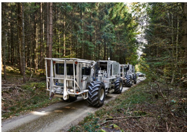
Bildbeschreibung: Vibrationsfahrzeuge der Firma DMT erzeugen Schwingungen im Untergrund, die gemessen werden und ein Abbild des Untergrunds ergeben. Bild: Beat Müller
